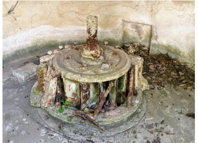
Die Francisturbine und Teile des regelbaren Leitwerkes sind erhalten. Die Welle zur Transmission des Generators ging heutzutage durch die Brücke hindurch.
